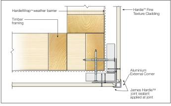
FIGURE 22 ALUMINIUM BOX CORNER OPTION - CAVITY TRIM
