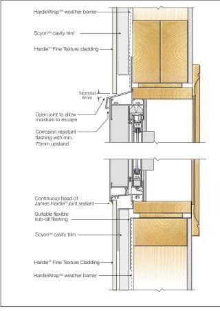
FIGURE 27 WINDOW HEAD AND SILL - CAVITY TRIM
