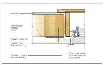
FIGURE 28 WINDOW JAMB - CAVITY TRIM
